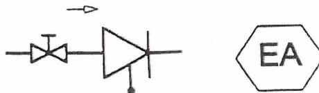
Bild 2 – Sicherungseinrichtung der Entnahmeverrichtung (Prinzip nach DIN 1988-2 und Symbol und Bezeichnung nach EN 1717)
