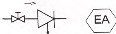
Bild 2 – Sicherungseinrichtung der Entnahmevorrichtung (Prinzip nach DIN 1988-2 und Symbol und Bezeichnung nach EN 1717)
