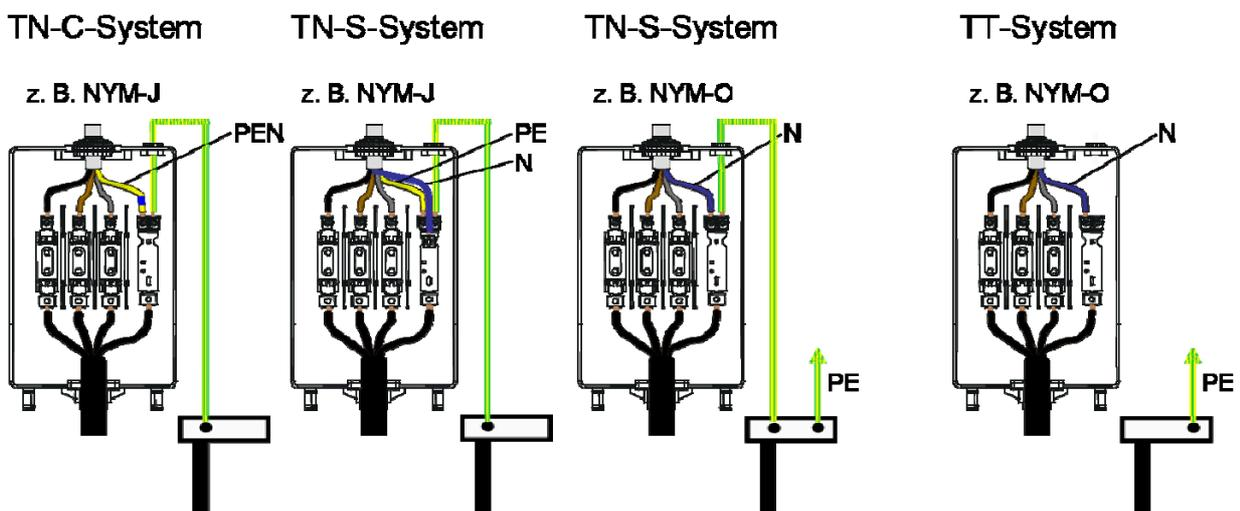
(2) Bei Verwendung von Hausanschluss- bzw. Zähleranschlussäulen erfolgt im TN-System der Schutzpotentialausgleich (Verbindung zur Haupterdungsschiene) - abweichend von oben dargestellten Bildern - von der ersten PEN-Klemme im Gebäude.
