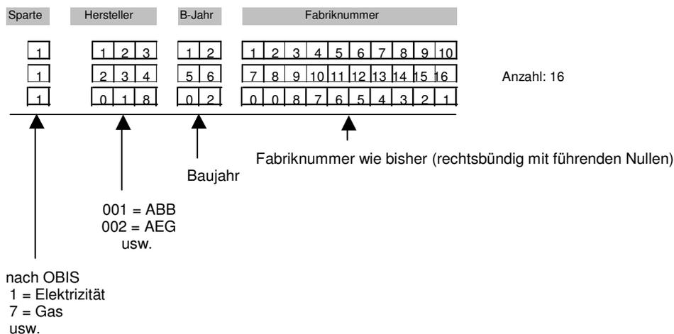
Abbildung 1: Aufbau der Identifikationsnummer
